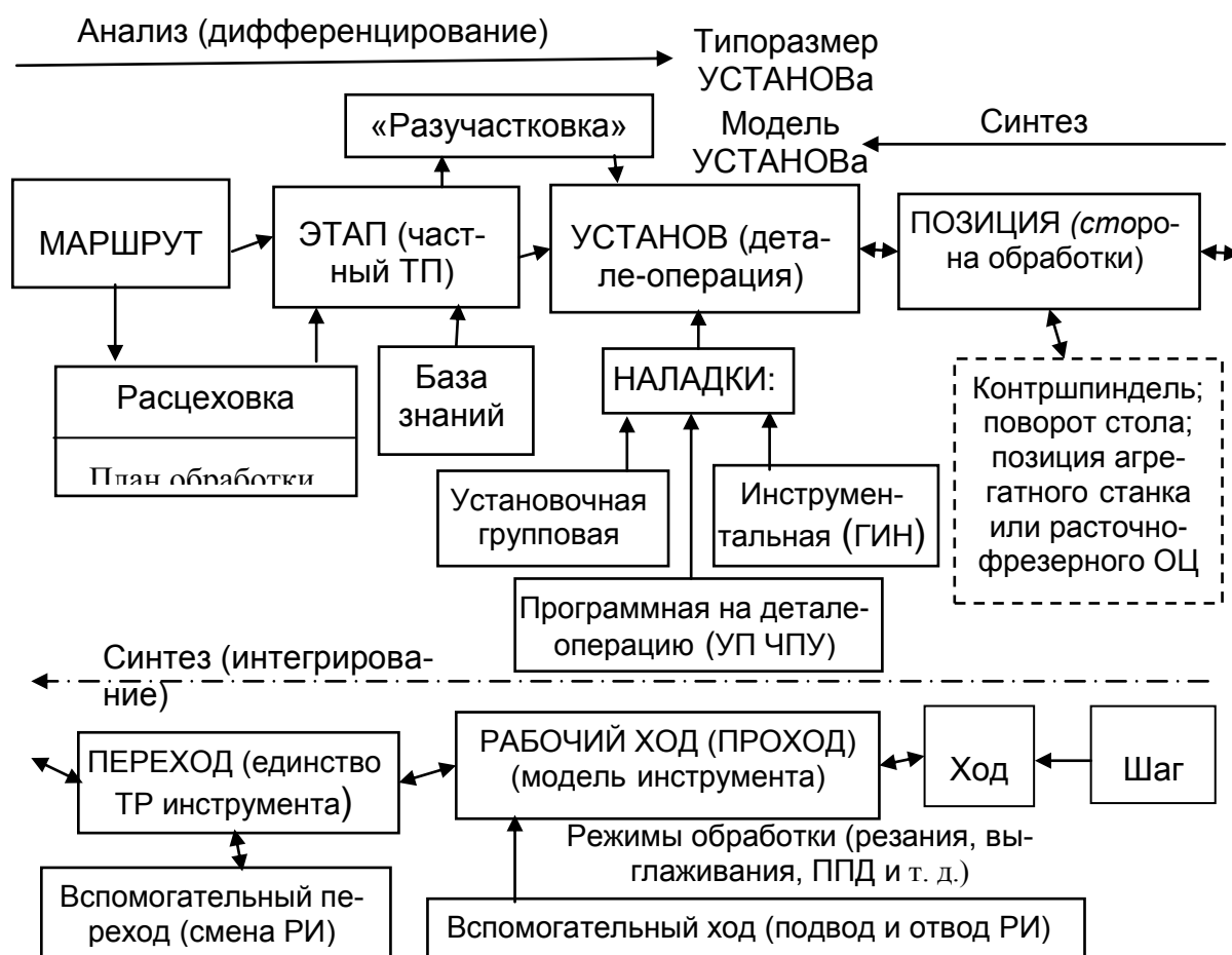
Рисунок 3. Структура ГТП и основные организационно-технологические мероприятия (приёмы) при разработке высокотехнологичных групповых процессов.
