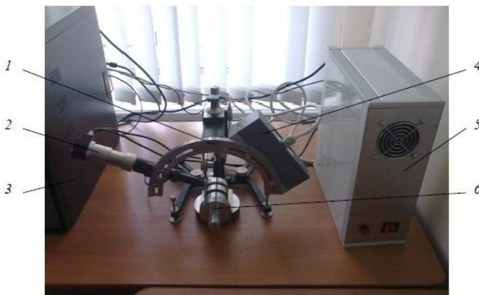
Рисунок 1. Конструкция рентгеновского измерительного комплекса «Рикор-7» 1 – гониометрический узел; 2 – рентгеновская трубка; 3 – компьютер; 4 – детектор; 5 – вычислительный блок; 6 – исследуемая деталь
